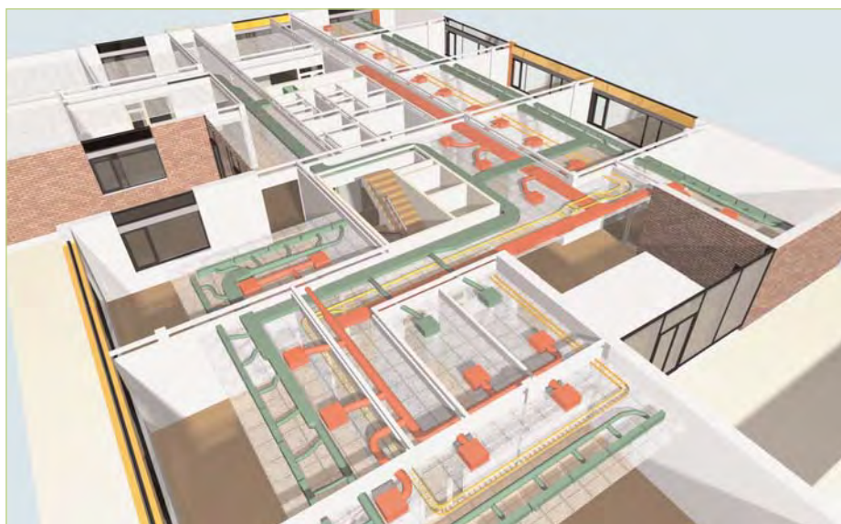
1. ábra. Épületinformáció-modellezés: modellalapú, integrált tervezési környezet, mely segíti a tervezők, mérnökök és kivitelezők nyílt, koordinált együttműködését
